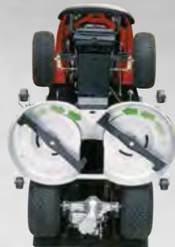
Plataforma de 102 cm. Equipada con doble cuchilla
