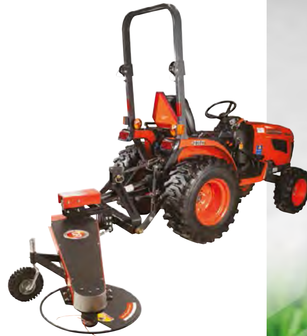
Cabezal Pivotante para evitar obstáculos fácilmente.
