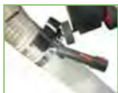
Mando acelerador con selector de potencia y arnés.
