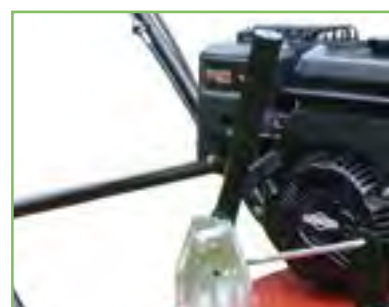
Regulación altura centralizada.
