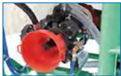
Bomba 50 Bar de 96 l/min y de 145 l/min.
