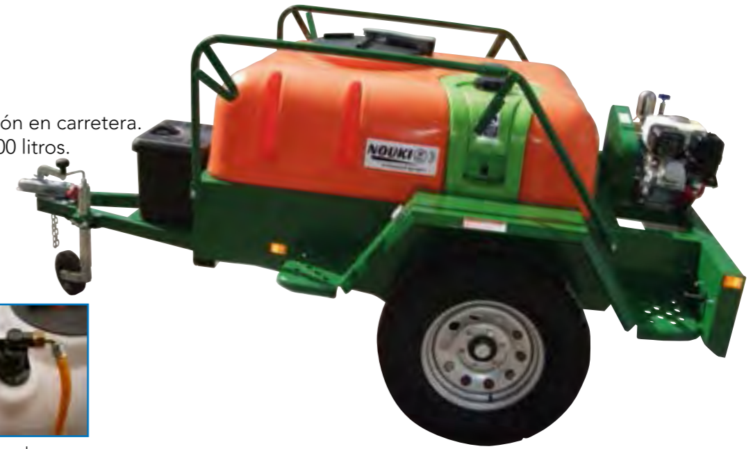
Hidrocargador ecológico con 5 m. de manguera.
